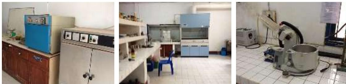
サンプル保存用冷蔵庫、恒温機、遠心分離機など。全て老朽化している。 分析に必要なエバポレーター。こちらも老朽化。
