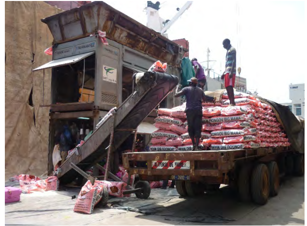
Photo 16 : Travail de mise en sacs à partir du silo et de chargement sur le camion, môle 1
