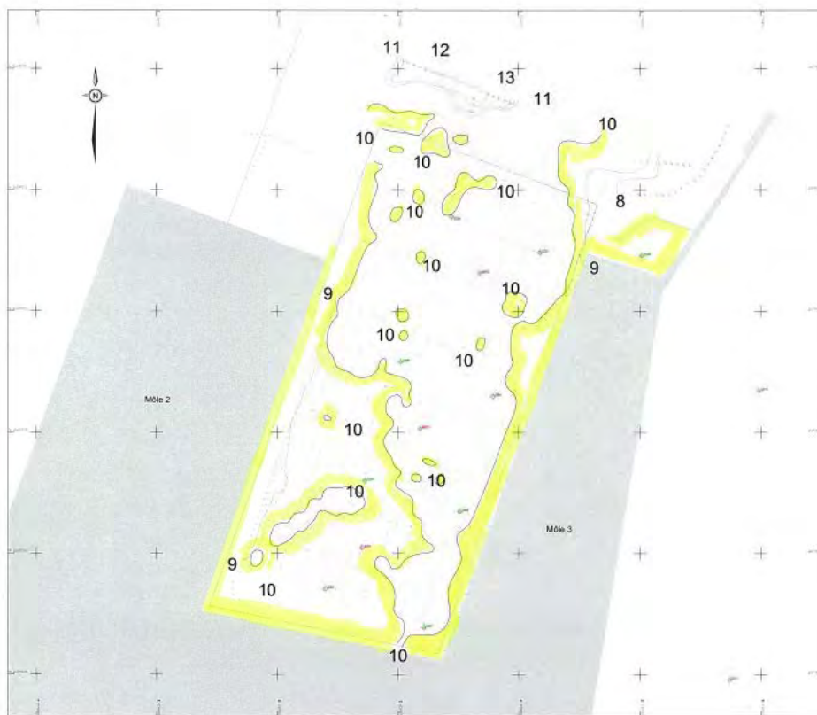
Figure 2-2-4 Résultat des mesures de la profondeur d'eau du Bassin Est (la zone en jaune a une profondeur inférieure ou égale à 10m)
