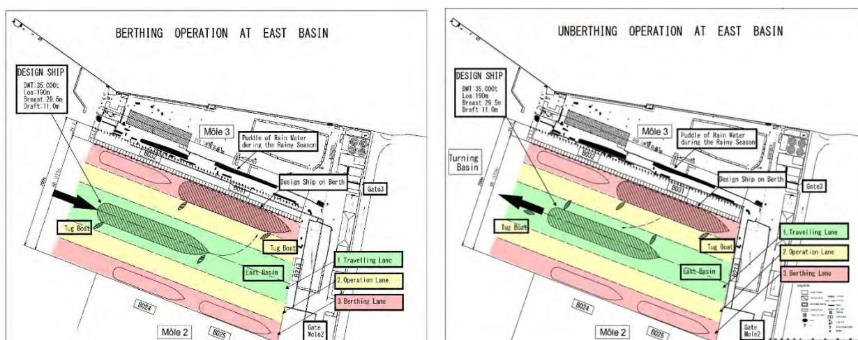
図 3-3-6 東埠頭における通常時の船舶の航行レーン構成と操船方法
