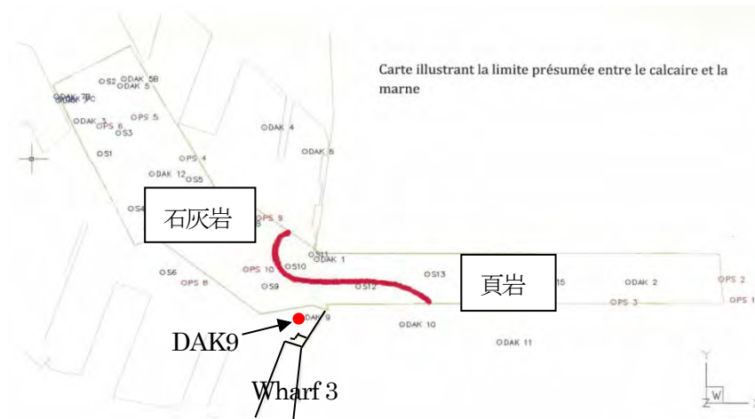
図 2-2-9 ダカール港の頁岩と石灰岩の境界 (JDN 社提供)
