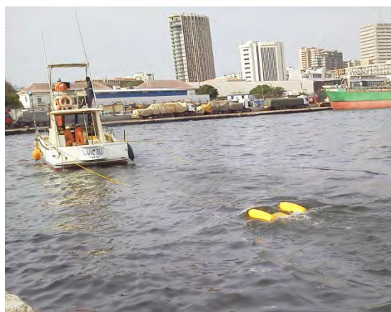
写真 2-2-1 地層探査中の観測船と牽引される C-Boom LVB
