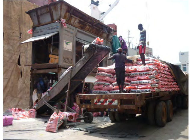
写真-16 第一埠頭での漏斗による袋詰めと バルコンでのトラックへの積み込み作業
