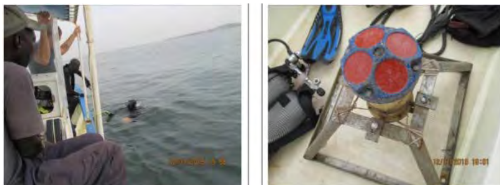
写真 6-3-2 潮流計 (ADCP) の回収状況 (左) と回収された ADCP
