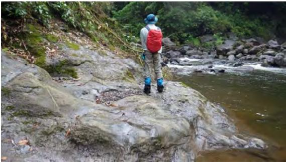
写真 3-22 (右岸)安山岩 CH 級の露岩状況
