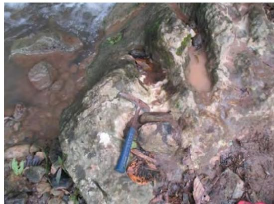
写真 3-5 (右岸) 石灰岩 CM 級岩盤
