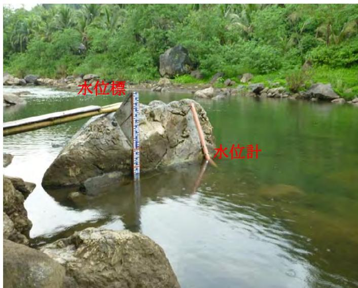
図 4-10 測水所設置完了
