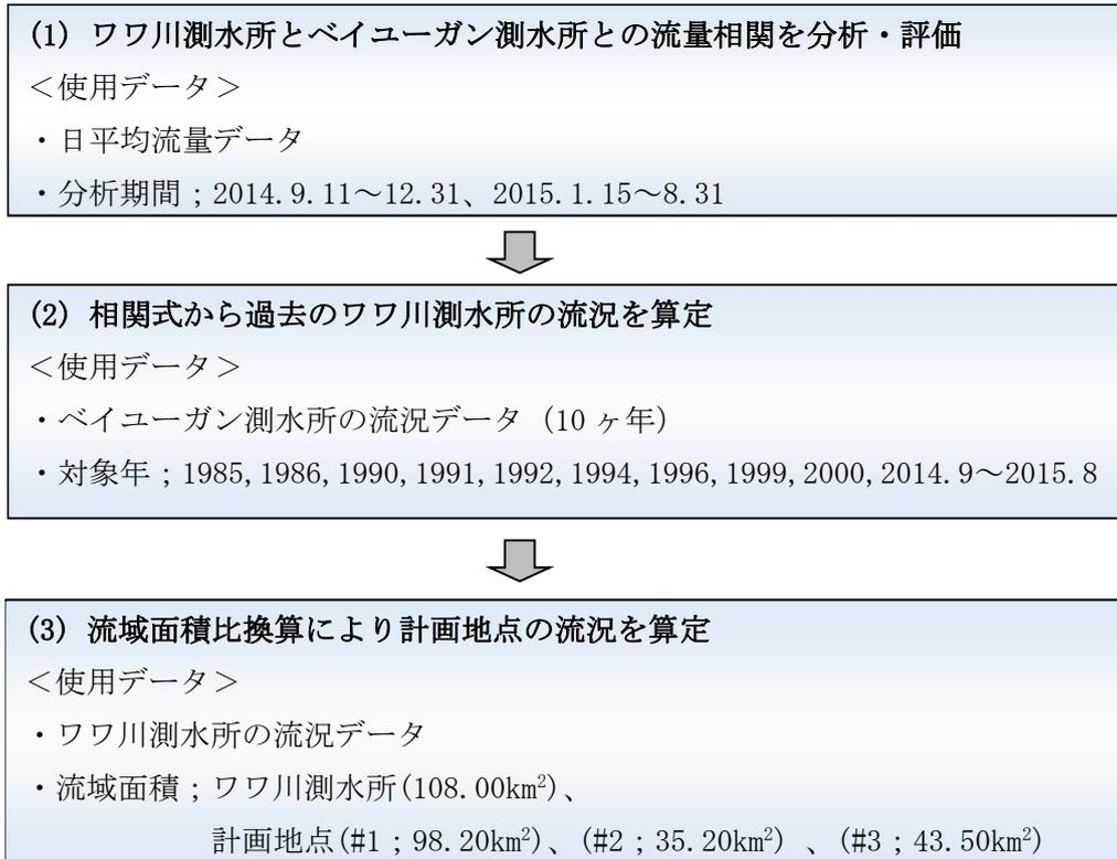
図 4-21 流況図作成フロー
