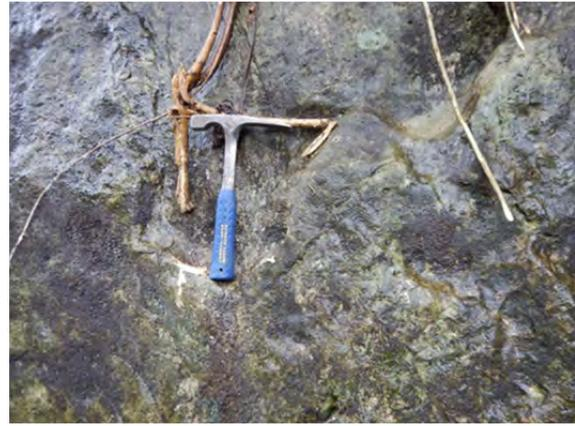
写真 3-11(右岸)同左 CM 級岩盤近景
