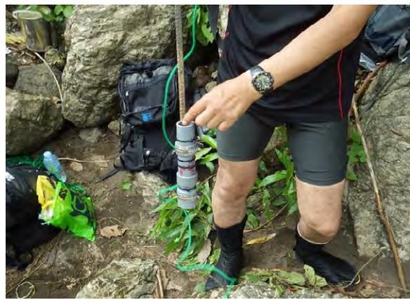
図 4-9 設置作業状況 (水位計)
