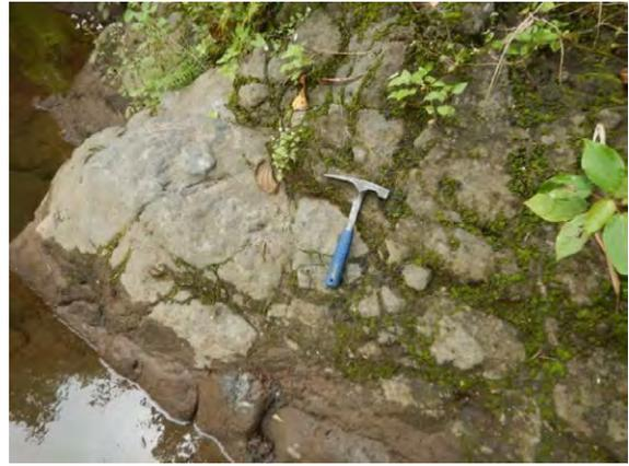
写真 3-39 (左岸)安山岩質凝灰角礫岩 CM 級岩盤
