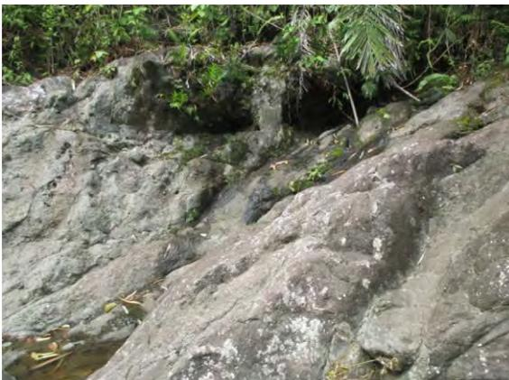
写真 3-6 (左岸) 安山岩質凝灰岩 CM 級岩盤
