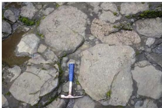
写真 3-19 安山岩 CM 級岩盤の柱状節理
