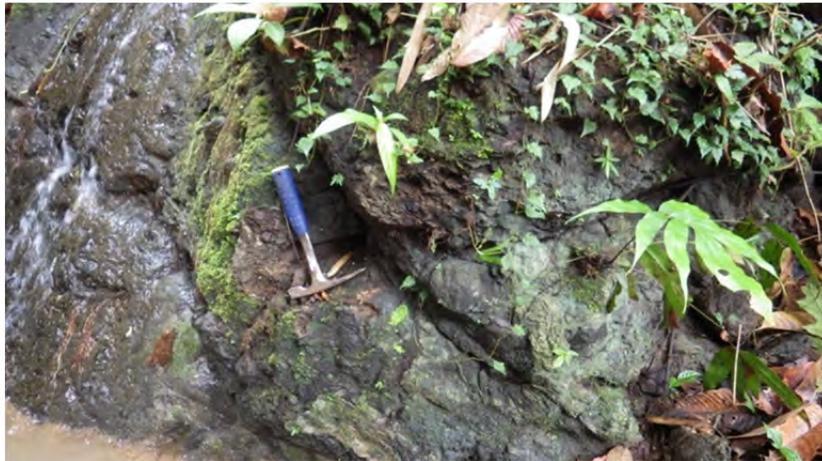
写真 3-3 (右岸) 安山岩質凝灰岩 CL~CM 級岩盤
