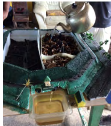
処分場見学者向けの模型で浸出水排水パイプと浸出水池のデモンストレーション。
