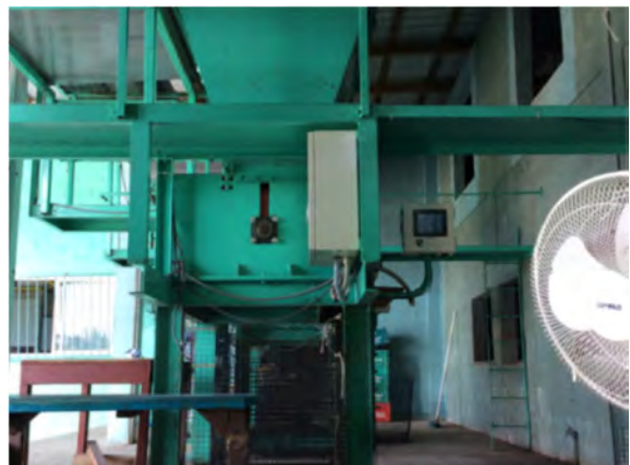
コロール州リサイクル・センターにおけるペットボトル計数機。本プロジェクトでは、容器デポジット・プログラムの運営管理にかかる国レベルの能力強化を実施。
