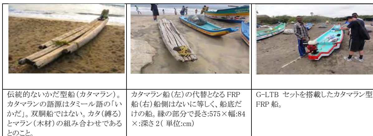
写真2：伝統的なカタマランとFRP製カタマラン
