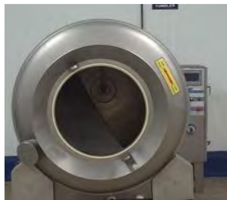
図 4-18 : ABFIの加工工場にあるバキューム転摩機（ビーフジャーキー等加工食品調理に利用）
