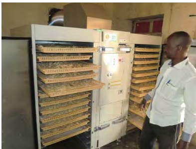
電気乾燥機の試験運転（OJT）
