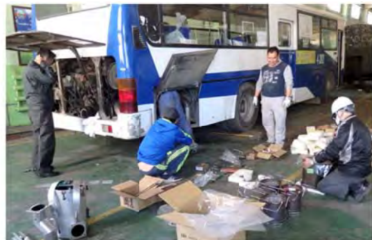
②DPF（モコビー）のDaewoo製バスへの搭載作業
