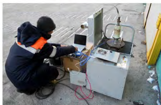
⑧屋外氷点下でのフィルタ再生テスト
