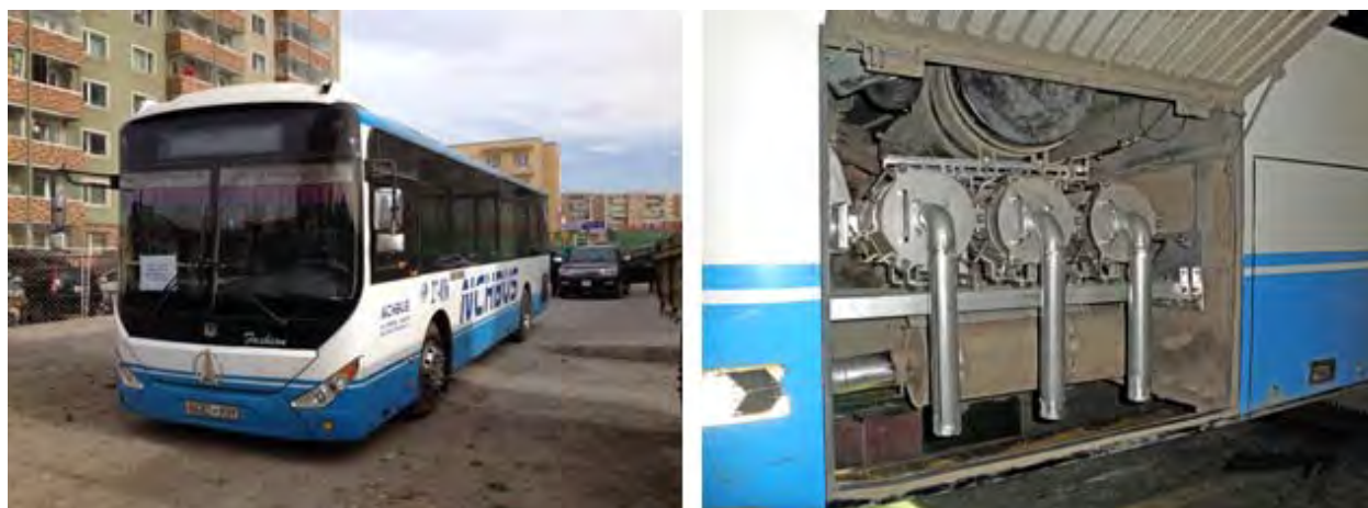
図 3－17 調査車両（Zhongtong 製バス）とモコビーCT3 取付状況
