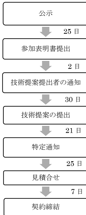
図 2.20 UR 都市機構の本工事におけるアットリスク CM 方式の手続きの流れ
