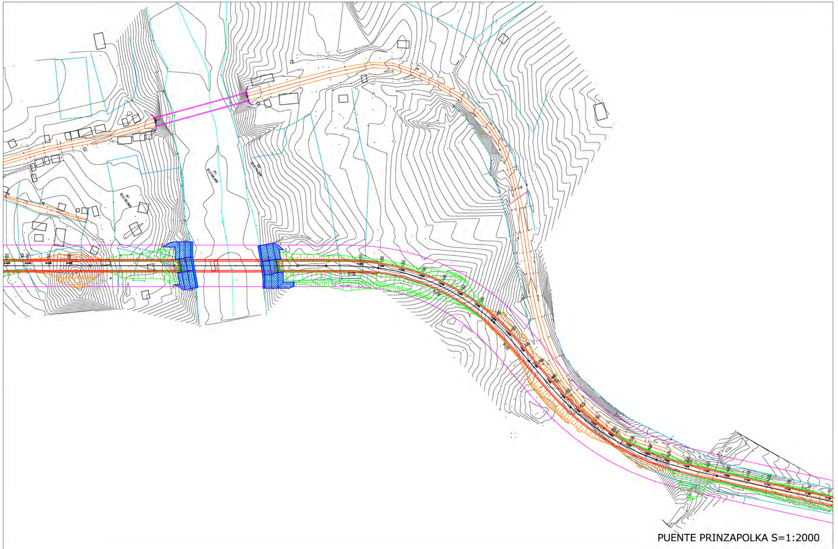
Figura 5-2-12 Plano en planta de la nueva ubicación del puente (Puente Prinzapolka(2/2))
