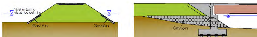
Figura 5-2-15 Obra de prevención de socavamiento alrededor del estribo A1 del Puente Mulukukú
