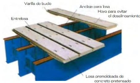
Ejemplo de losas de hormigón pretensado y prefabricado
