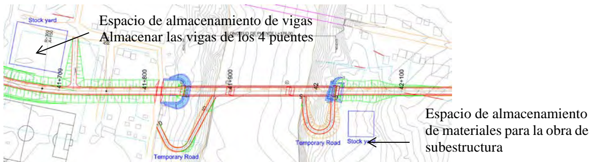
Figura 5-2-35 Obras provisionales en Mulukuku
