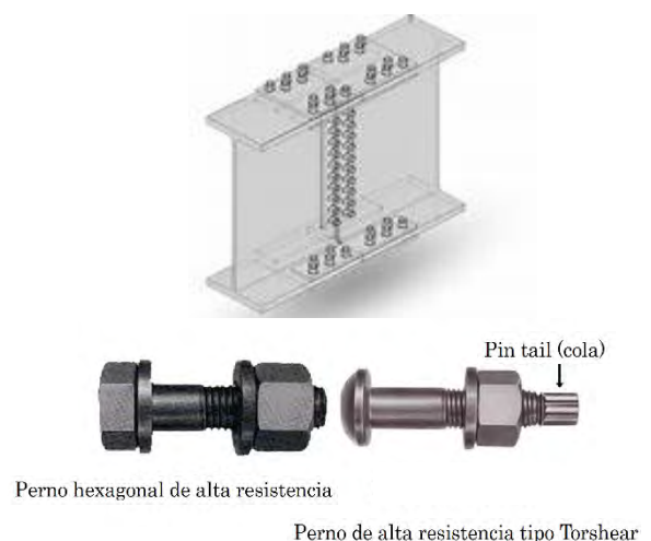
Figura 5-2-46 Resumen de perno de alta resistencia tipo Torshear
