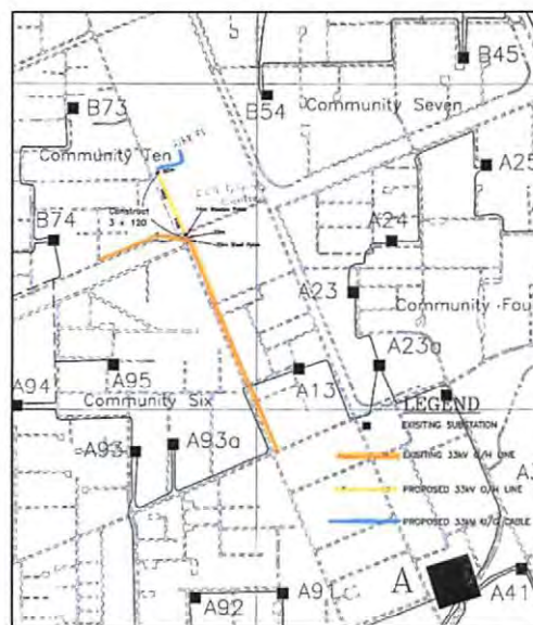
図3-3 33kV 配電線路ルート設計書の例
