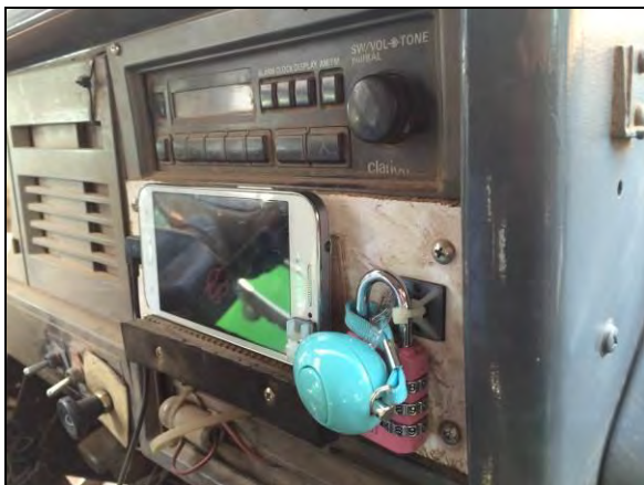
車載用端末の盗難対策 —ブザーとダイヤル ロックの取付— (2016年2月)
