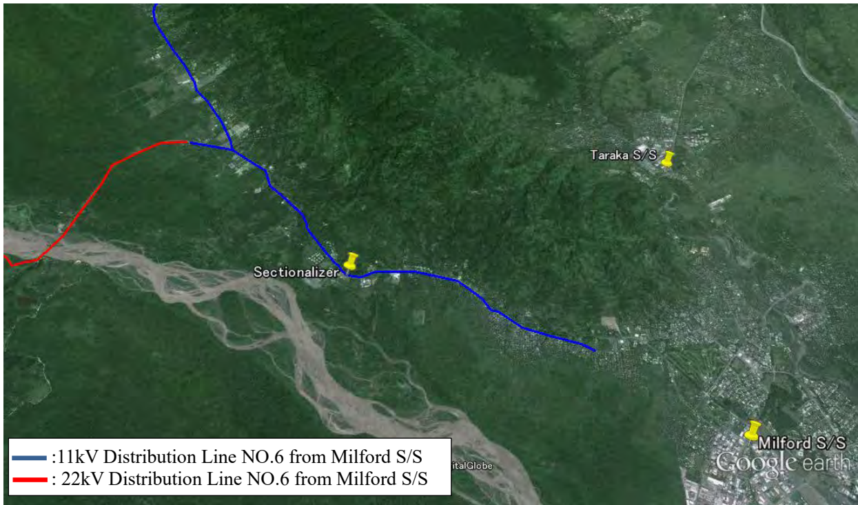
図 2-17 区分閉器の設置場所
