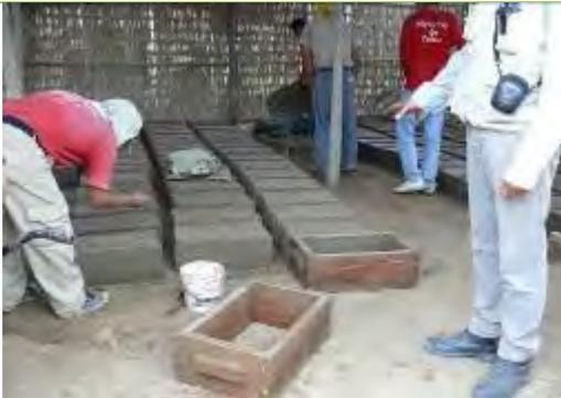
写真-11：修復用の日干しレンガを作る遺跡内にある作業場。レンガのサイズは時代によって異なるため、様々なサイズの型枠を使用している。
