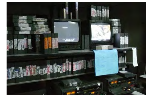
写真-7: マスタールームにある VTR 再生機。現在は BETACAM と DVCPRO を使用している。
