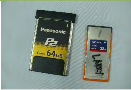
写真-9: ハイビジョンカメラで使用されている記録媒体。SXS(Sony)もしくはP2(Panasonic)を使用。
