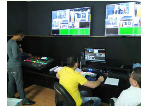
写真-7: サブコントロールルーム。照明、音声、カメラなどスタジオ撮影の調整を行っている。
