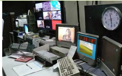
写真-6: 仮設のマスターコントロールルーム。奥の画面では屋外カメラ、スタジオ、VTR からの映像が流れスイッチャーで選択して放送する。
