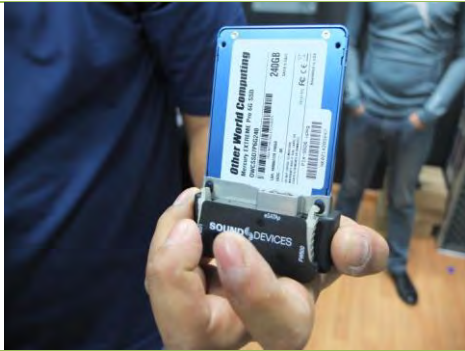
写真-9:番組データの記録媒体である SSD。TNH では番組データは基本的にソフトデータにより保管している。
