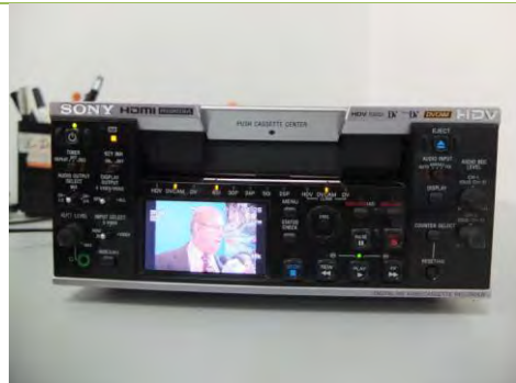
写真-14:Sony 製の番組ソフト再生機。DVCAM・HDV 対応。
