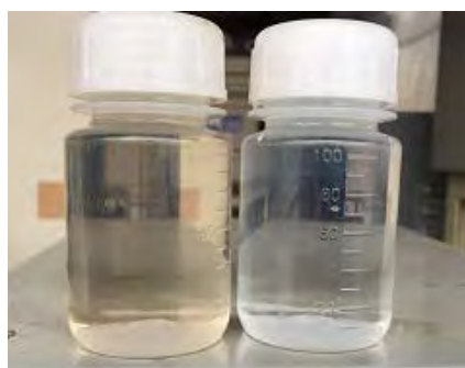
図 3.9 原水（左）及び処理水（BV24倍）
