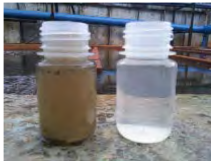
図 3.6 原水（写真左）及び活性炭処理水（写真右）
