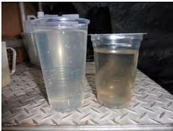
図 3.14 処理水 (BV 約 4 倍) (左) 及び処理水 (BV 約 50 倍) (右)
