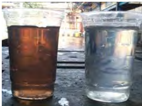
図 3.15 原水 (左) 及び処理水 (BV 約 2 倍) (右)
