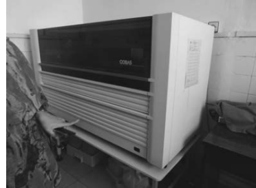
・国立公衆衛生研究所-2 PCR装置。HIVや結核菌の特定に用いられる。
