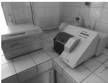
・国立公衆衛生研究所-1 エライザマイクロプレートリーダー（HIV、B型・C型肝炎ウイルス検査に用いられる）
