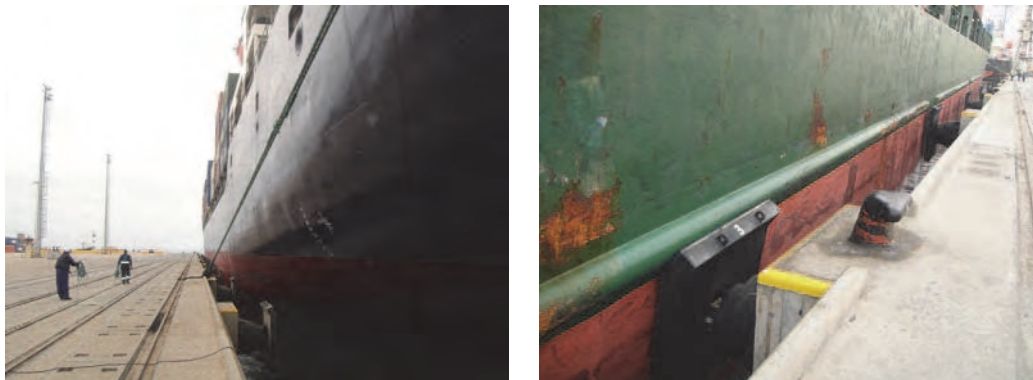
Figura 3.11 Contacto da Parte Encurvada e Faixa Saliente do Casco do Navios com a Defesa
