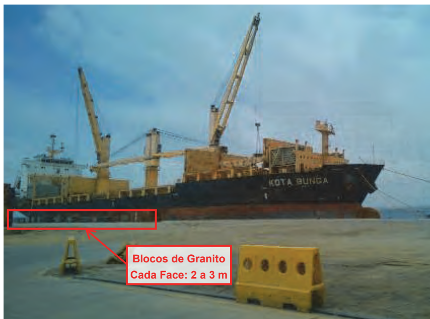
Figura 3.4 isposição dos Blocos de Granito
