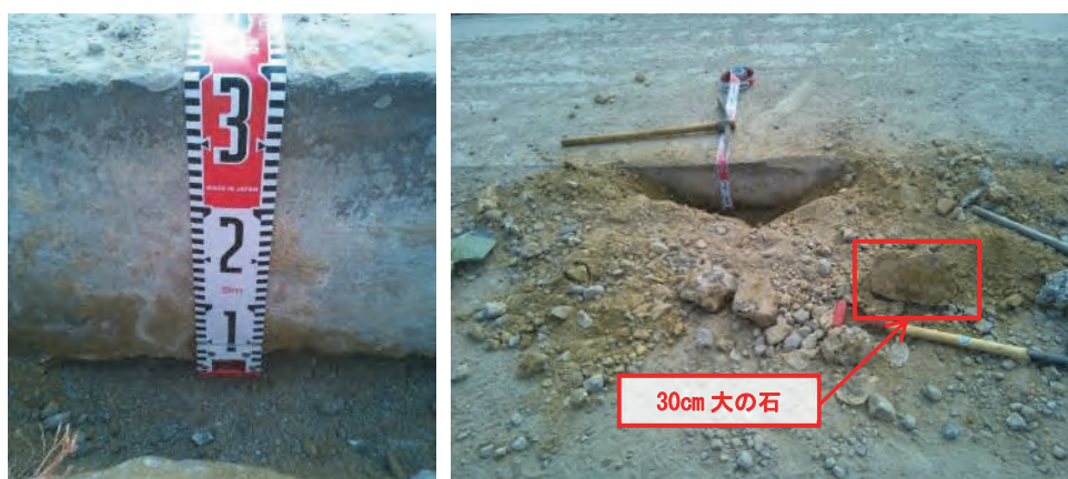
図 3.3 エプロン舗装厚 ( t = 30\text{cm} ) の確認
