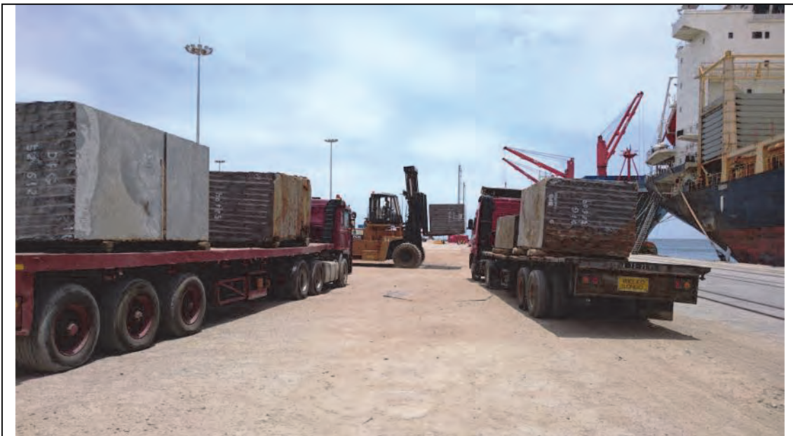
現況写真-6 ナミベ港 3B 岸壁ヤード現況 グラナイト切石運搬荷役状況、未舗装、凸凹あり
