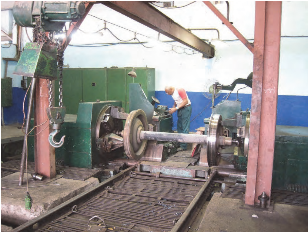
写真1:Luyano 工場(客車/貨車)内の老朽化した機器(車輪研磨機)
