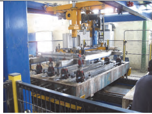
(4) 鉄筋の型枠への挿入
