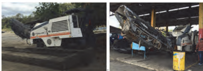
図 7-19 キューバに2台ある Wirtgen 製 W130F フレスカ盤(路面切削機)(右側は故障中)
