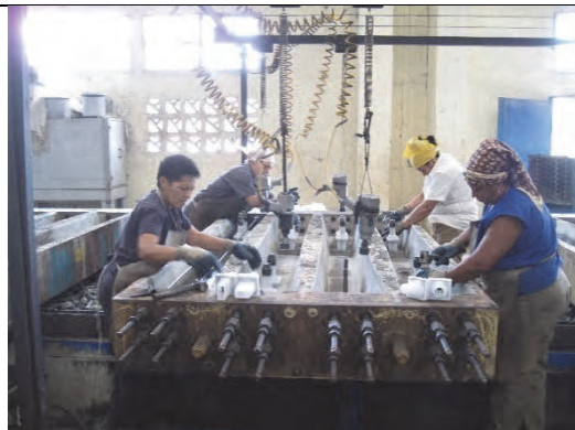
(5) 枕木への締結装置部品の取付
