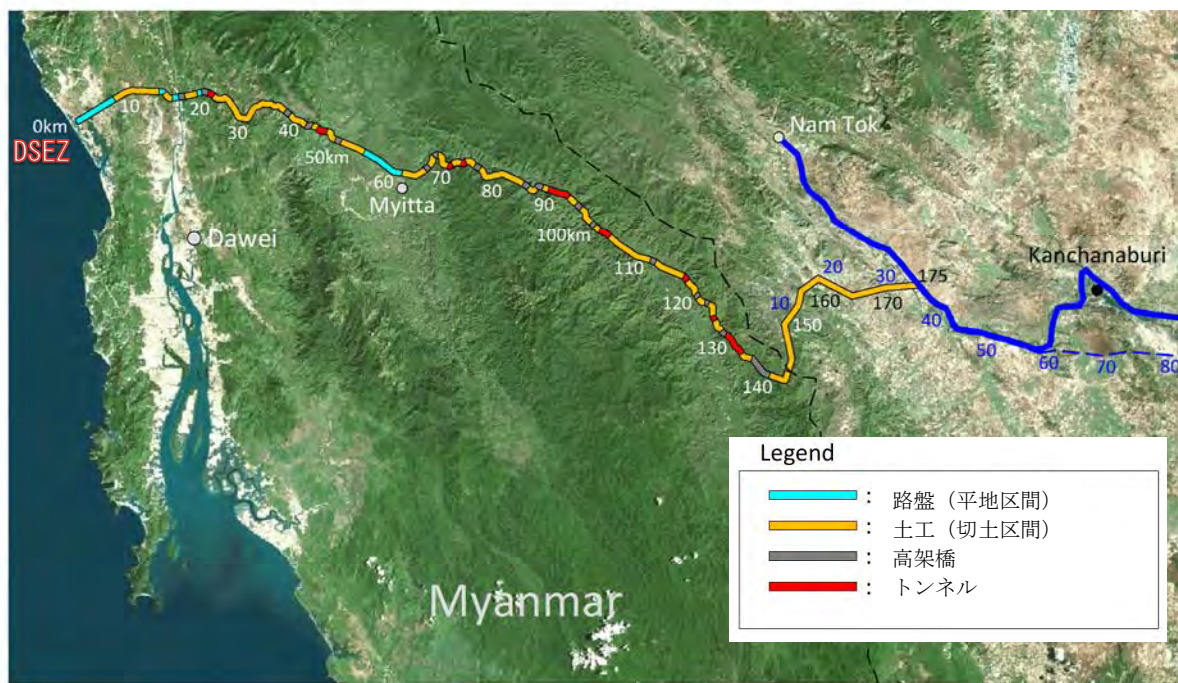
図 6.2.7 鉄道構造物の配置概要図
