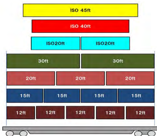
図 6.3.2 コンテナの積載イメージ
