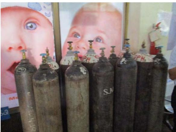
写真 3.2 シリンダーが転倒防止柵のない状態で通路に置かれている
