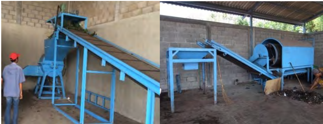
有機ごみを砕く破砕機（左）、熟成した堆肥から異物を取り除くトロンメル（右）
