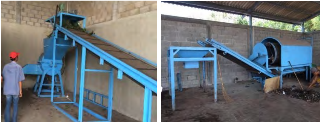
有機ごみを砕く破砕機（左）、熟成した堆肥からごみを取り除くトロンメル（右）
