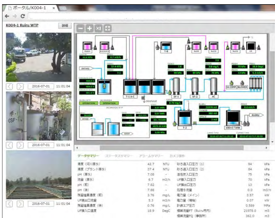
図 16 遠隔監視システムの画面例
