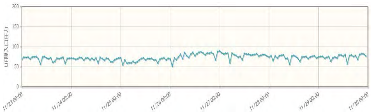
図 14 実証装置の膜ろ過圧力 (2015年11月23日～30日)
