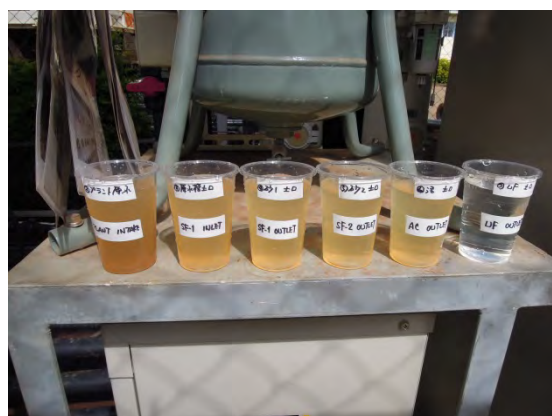
写真3 処理状況 (酸化+膜ろ過法)
