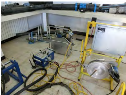
No. 55 ポリエチレン管溶着器 (研修センター)
