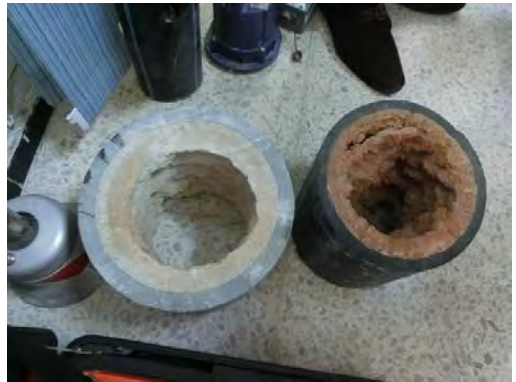
No. 20 詰まりのある石綿セメント管 (左) と ポリエチレン管 (右)
