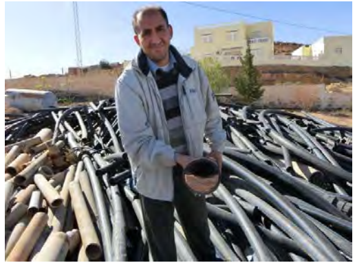
No. 18 スケールの詰まった配水管 (ポリエチレン管) 南部の営業所では同様の問題を抱えている
