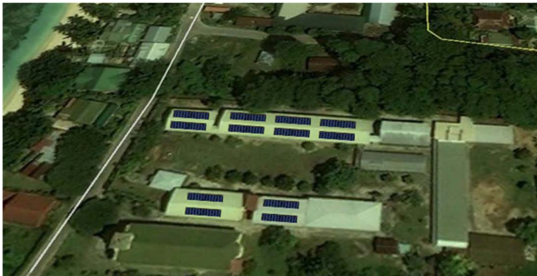
図 3.3.2-3 学校建屋屋根設置イメージ
