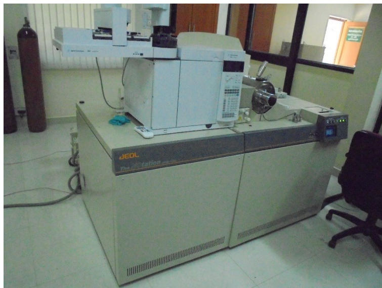
写真9 高分解能ガスクロマトグラフ/二重収束型高分解能質量分析計（NEERI 所有）
