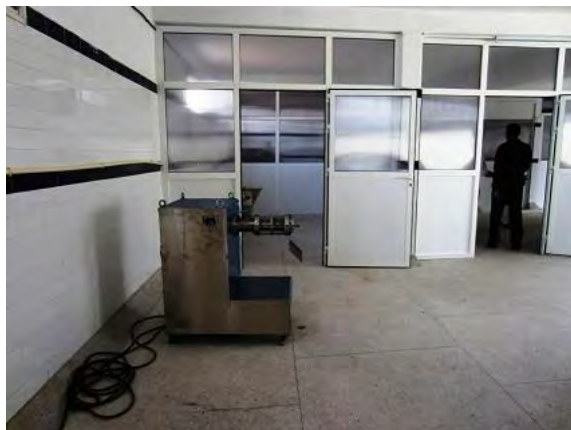
ONSSA 指導により種子オイル種別による搾油室別室化と搾油機設置対策（2016年5月調査団撮影）
