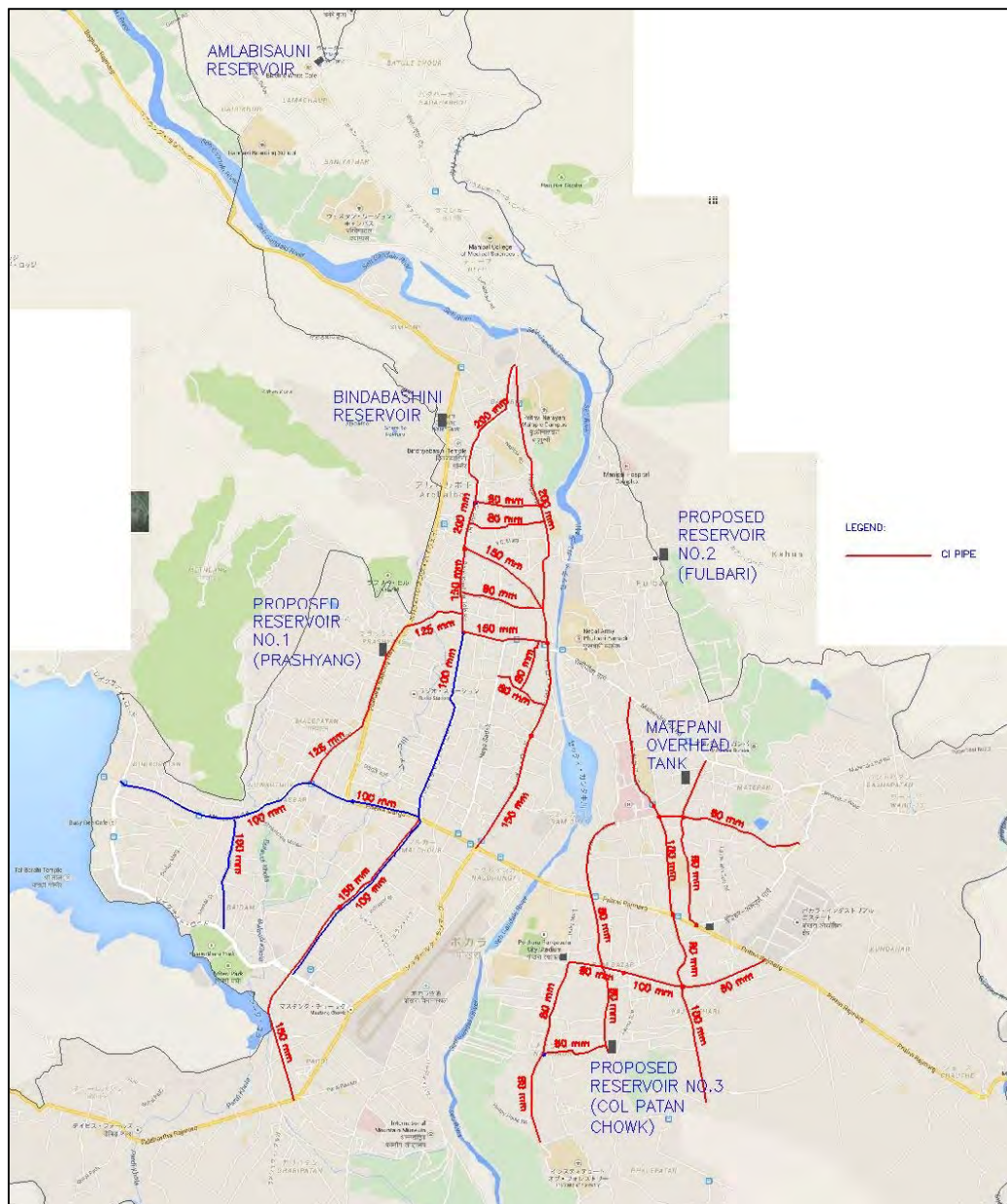
図 3-2-17 既設の CI 管路
