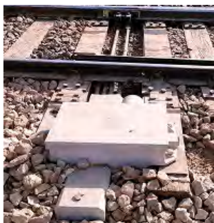
図 6-6 PR 本線に設置されている継電連動装置と電動式転てつ機
