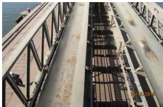
図 4-5 IOCB の栈橋とアンローダーとベルトコンベアー
