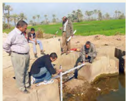
パイロットサイトでの施設の調査。水利施設の老朽化の状況等を農家と一緒に確認
