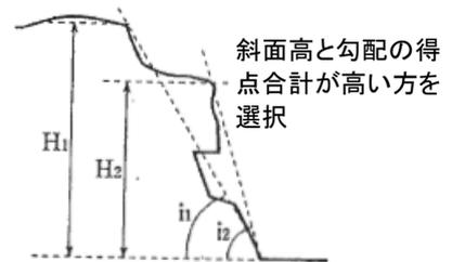
図 3.5.6 斜面の高さや傾斜の計測手法 (出典：財団法人道路保全技術センター2007\*<sup>1</sup>)
