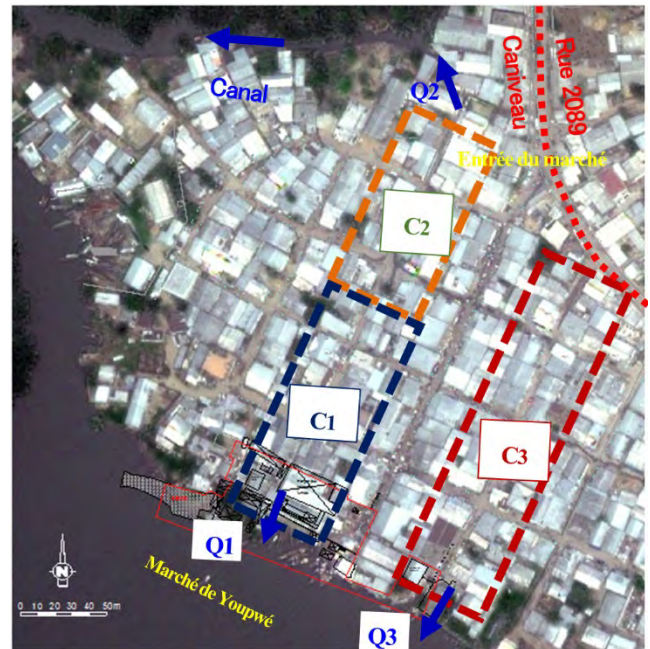
Figure 2-29 : Bassins de drainage des eaux
