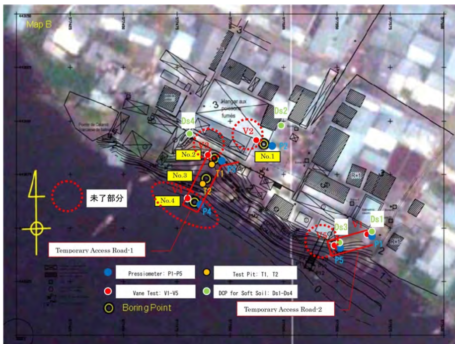
Figure 1-8 : Emplacements d'essai sur le site
