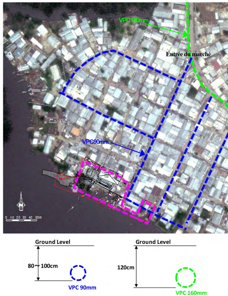
Figure 2-23 : Plan d'emplacement des canalisations d'eau enfouies
