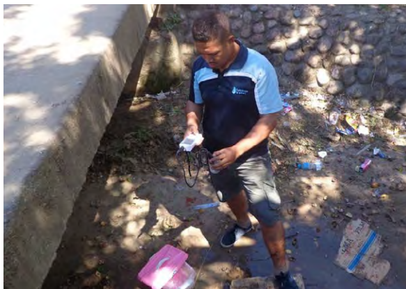
図 6.4-1 残留塩素計を使った地表漏水の確認調査
