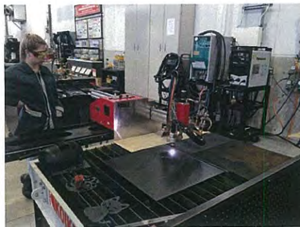
[PNC-12 によるプラズマ切断の実演]
