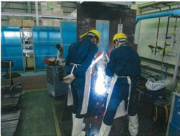
5月24日：SEG 実習（突出し・銅板・開先条件）
