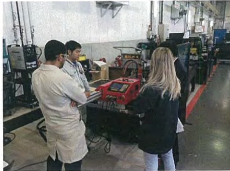
[PNC-12 によるプラズマ切断の実演]
