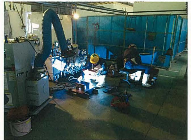
5月25日：SEG 実習（仮付溶接）
