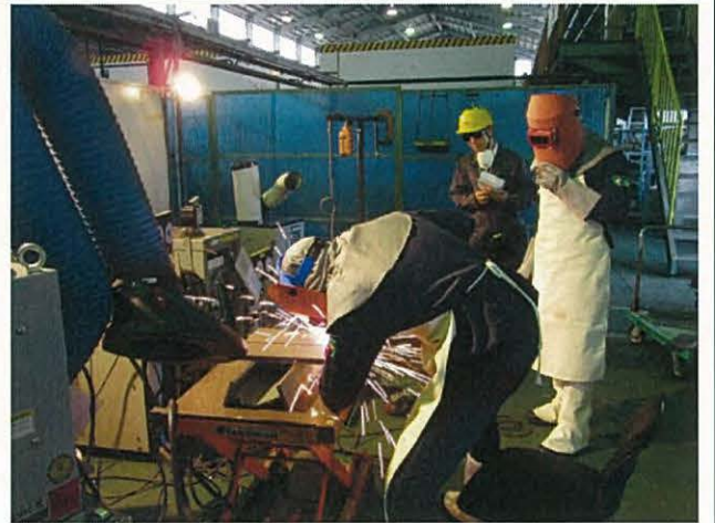
5月17日：片面溶接（初層溶接条件）
