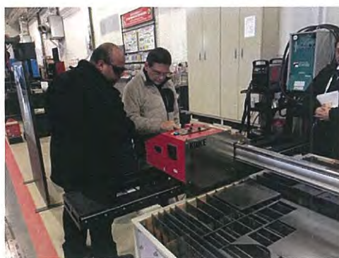
[KAP で作成したプログラムを PNC-12 に入力して切断]
