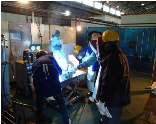
すみ肉溶接 使用ワイヤ：MX-200 電流：300A-32V-40cpm
