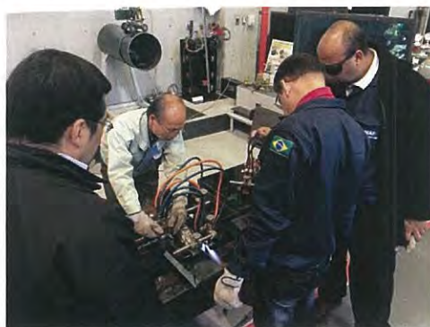
[IK-93 によるツイントーチによる開先同時切断]
