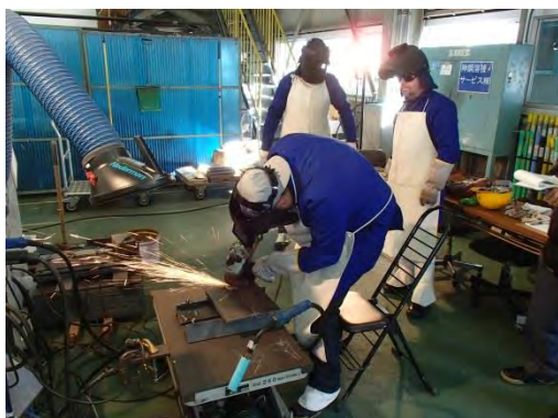
片面半自動溶接 仮付け中
