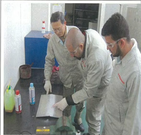
溶接部の染色浸透探傷試験実技
