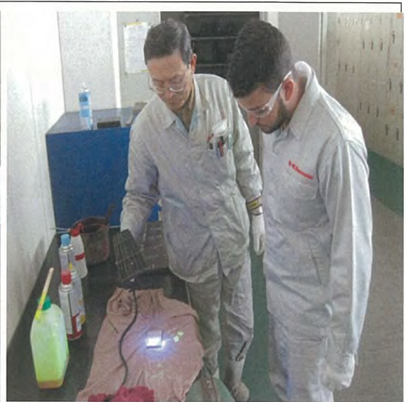
対比試験片による蛍光浸透探傷試験実技
