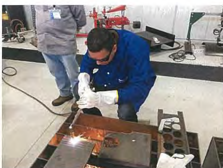
[ハンドトーチによる切断実演] *コツをつかんで、一人で切断が出来るようになった
