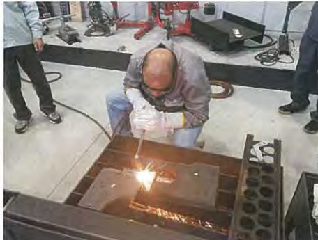
[ハンドトーチによる切断実演] *コツをつかんで、一人で切断が出来るようになった
