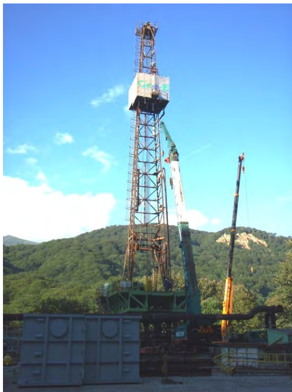
図 3-48 ロータリーテーブルタイプ (S-32) のリグ写真 (岩手県葛根田)
