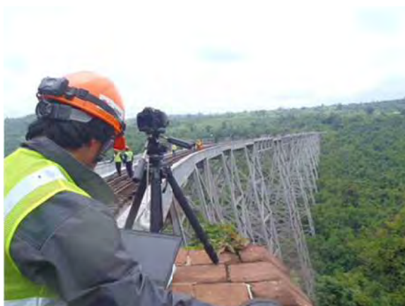
ゴッティー橋梁の変位測定の様況
