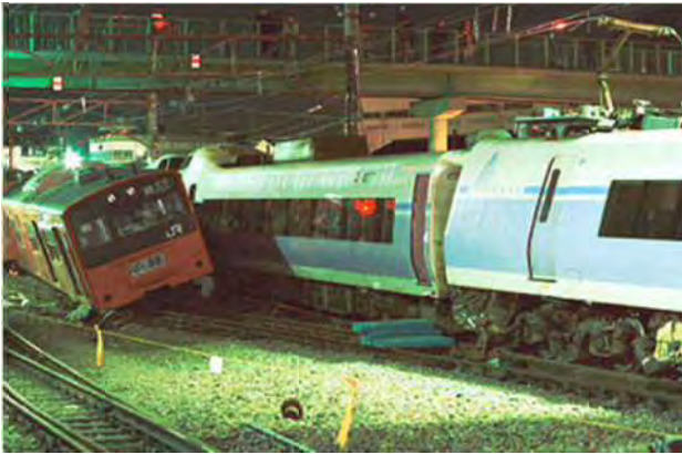
JR中央本線 大月駅構内 衝突脱線事故例
