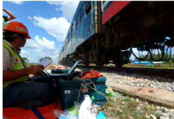
走行確認試験
