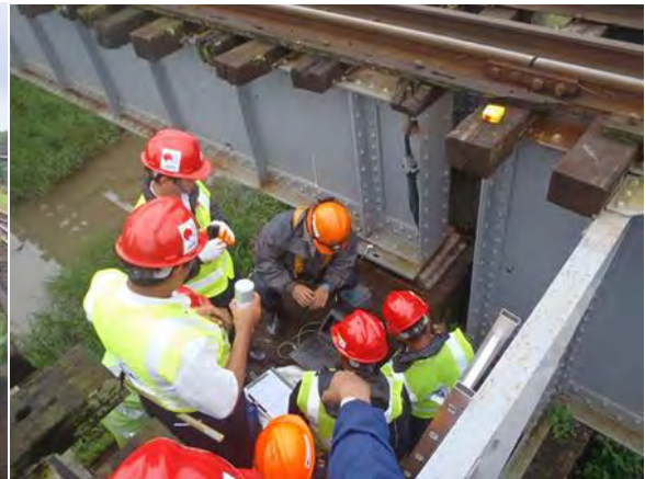
(2) No13 Bridge(2) 応力測定訓練
