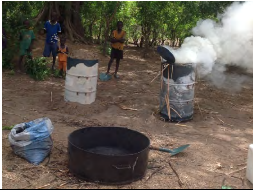
Fabrication de briquette de charbon provenant de tiges de typha (AP5)
