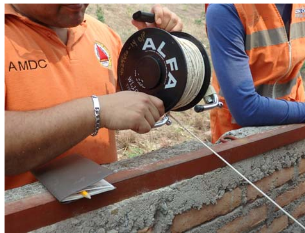
Bajar con cuidado el sensor dentro del pozo
