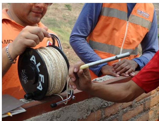
Cable con escala y sensor
