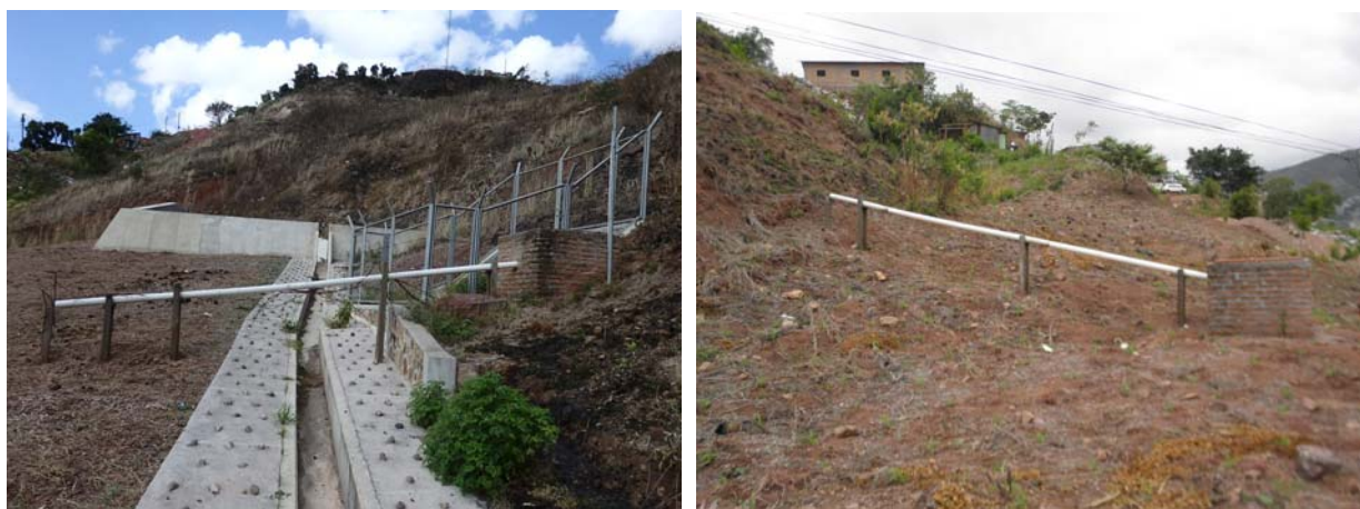
Figura 1.3.1 Extensómetro de la superficie de la tierra instalado en la zona de El Reparto (Fuente: JCT)
