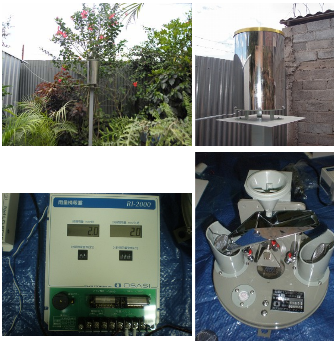
Figura 1.5.1 Pluviómetro instalado en la zona de El Reparto (Fuente: JCT)
