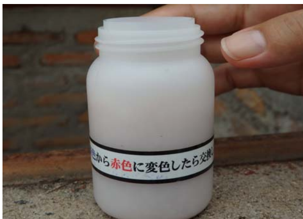
Confirmar que el desecante no se haya puesto de color rojo. En caso afirmativo, el desecante debe ser cambiado por otro nuevo, o secarse en el horno microondas, etc.
