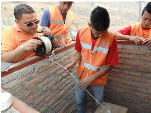
Figura 1.4.1 Medición manual del nivel por contacto (Fuente: JCT)
