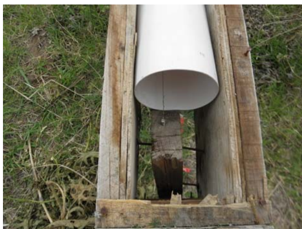
Choque del tubo de protección con la estaca de referencia (Causa de movimiento diario)
