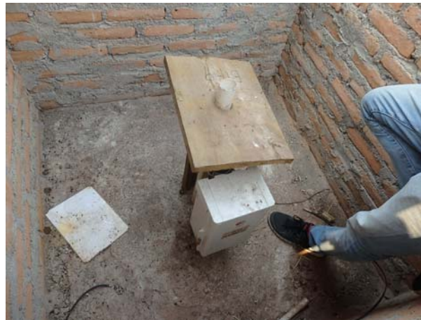
Figura 1.4.1 Medición manual del nivel por contacto (Fuente: JCT)
