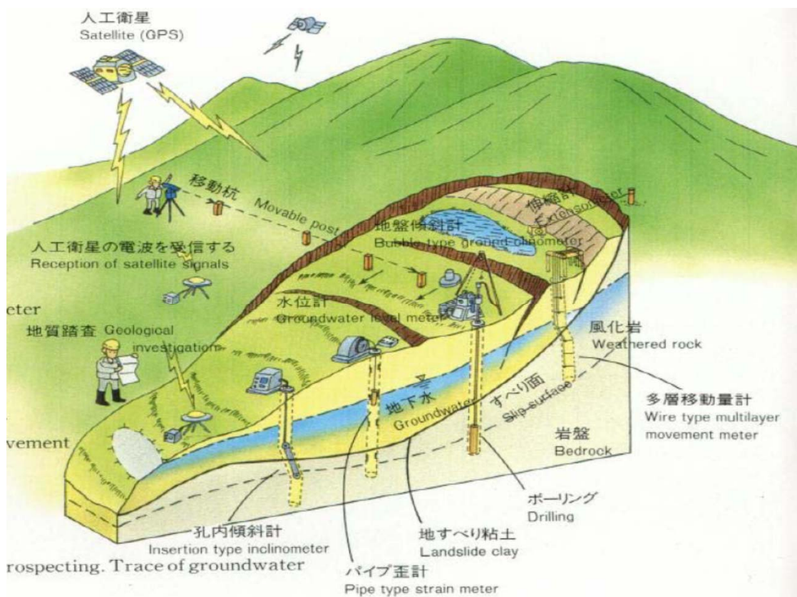
図1.1.1 地すべりモニタリング模式図
