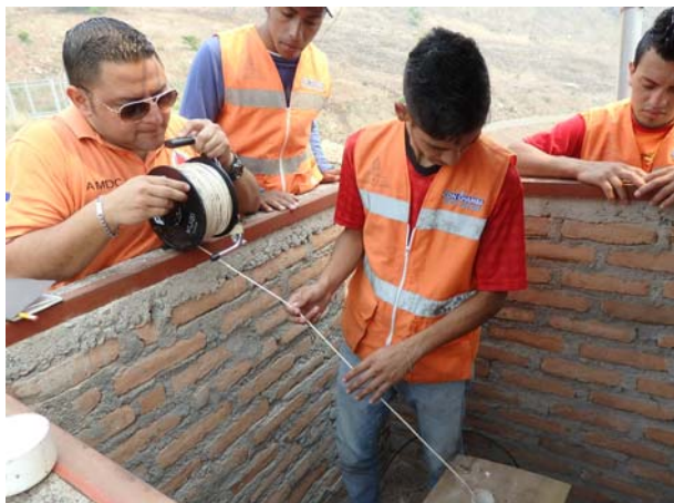
図1.4.1 手動接触式の水位観測（出典：JCT）
