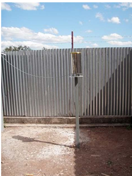
図1.5.2 雨量計設置の例（出典:JCT）
