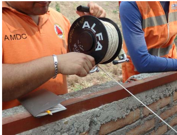
センサーを観測孔内に慎重に下ろす
