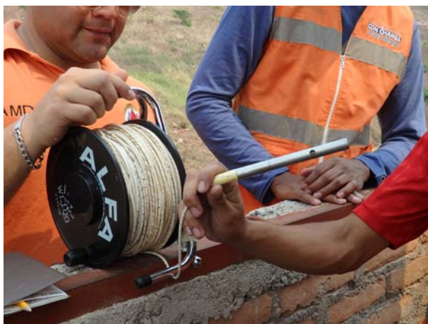
目盛り付きケーブルとセンサー部分
