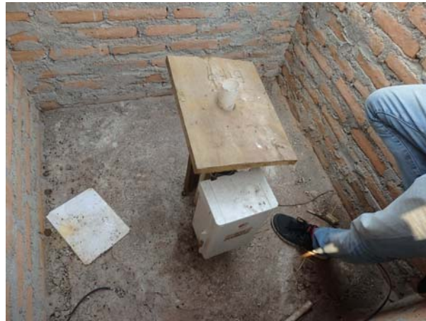
図1.4.1 手動接触式の水位観測（出典：JCT）
