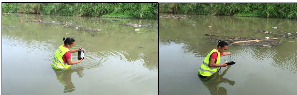
図 22-3 水質調査状況 (室内分析用サンプリングおよび多項目水質計による測定)
