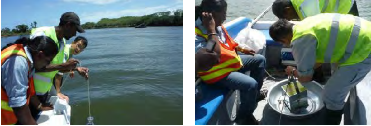
図 9-7 水面下における河床材料の採取（感潮域、デナラウ湾）
