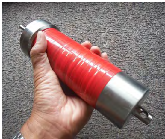
写真 9-2 使用した観測機器 (左：濁度計全体、右：センサー面)
