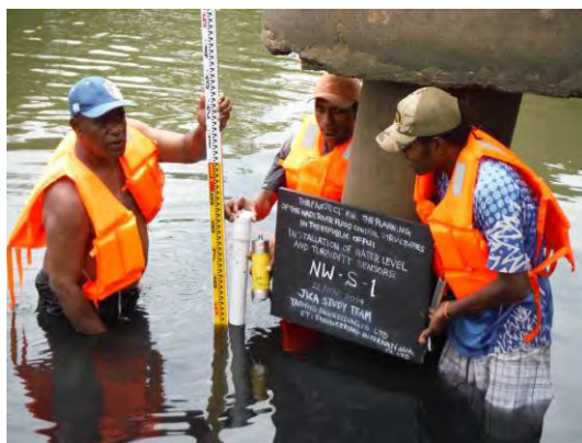
写真 9-3 観測機器の設置状況 (ナワカ川 ナブ・ブリッジ)
