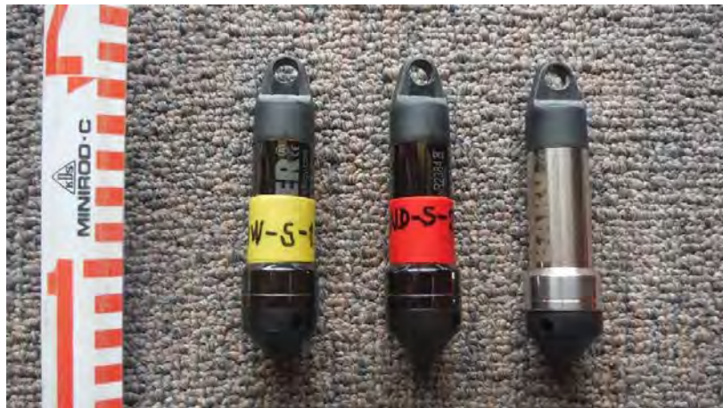
写真 9-1 使用した観測機器 (左側2本が水位計、右が大気圧計)
