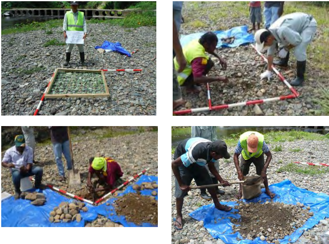
図 9-8 河原における河床材料の採取（河川中流・上流）
