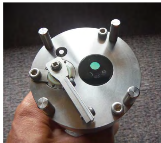
写真 9-2 使用した観測機器 (左：濁度計全体、右：センサー面)
