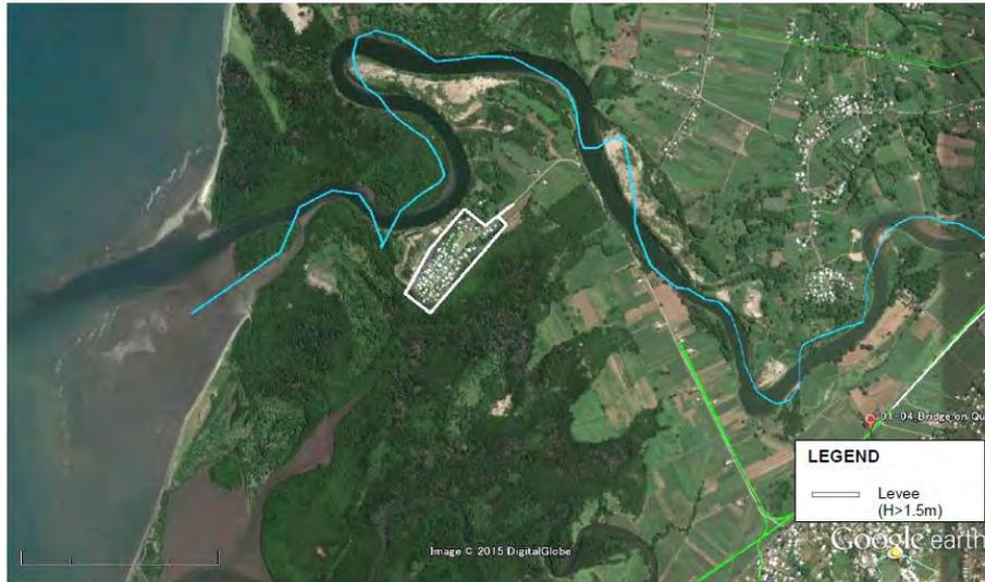
図 8-57 輪中堤平面配置
