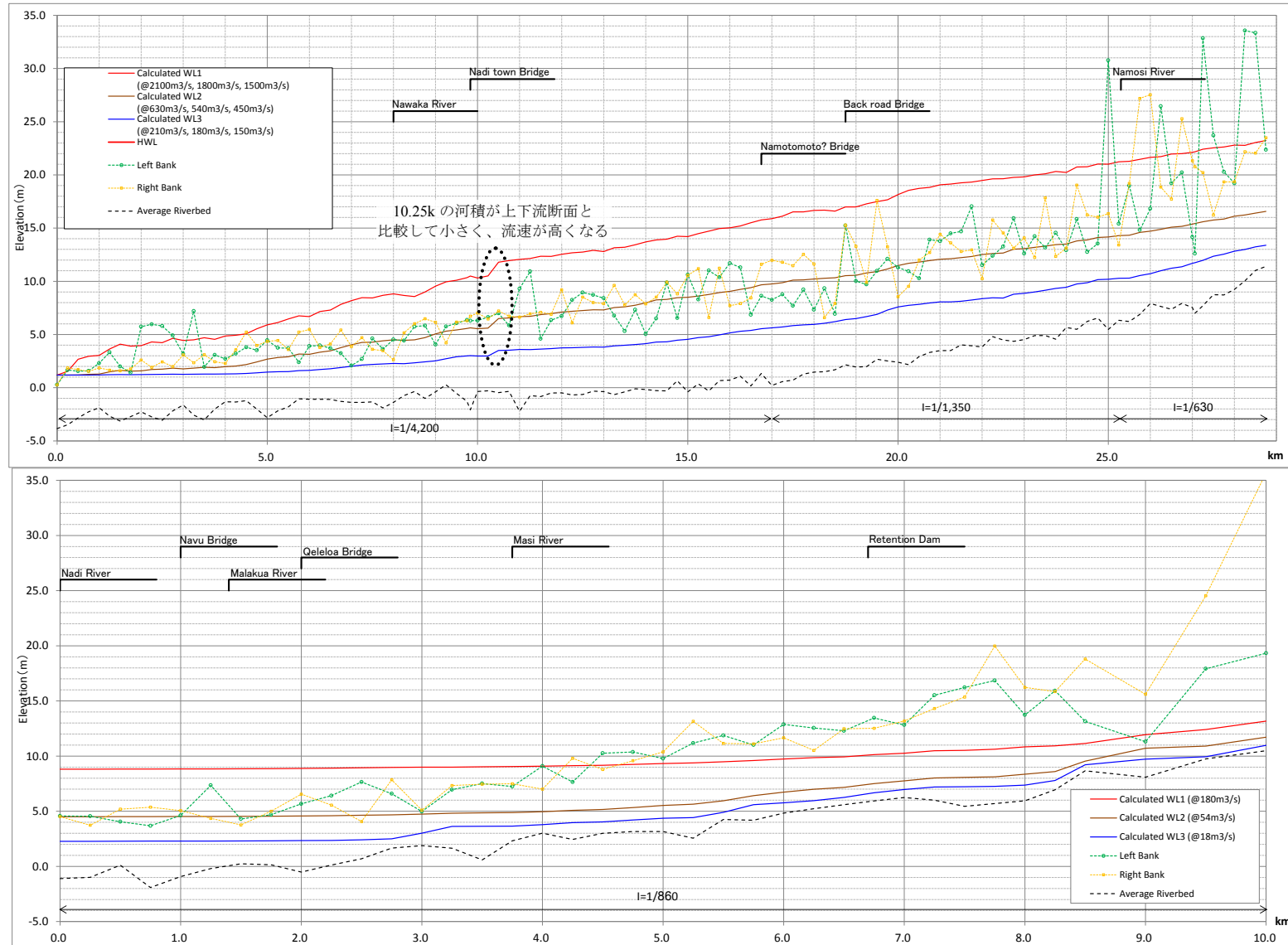
図 5.3-16 水位縦断面図① (上図：ナンディ川【～8.00k : 2,100m 3 /s、～25.25k : 1,800m 3 /s、25.50k～ : 1,500m 3 /s 等】、下図：ナワカ川)
